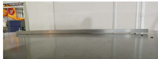
1.5ton 荷重後の蓋の変形 ⇒ 雨水が溜まる永久歪み変形
