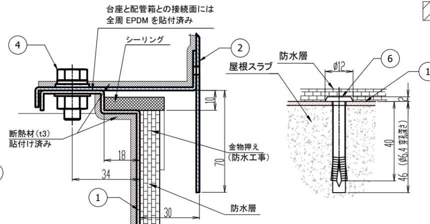
DETAIL B (台座-配管箱 接続部)
