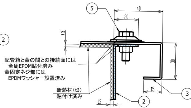
DETAIL A (蓋-配管箱 接続部)
