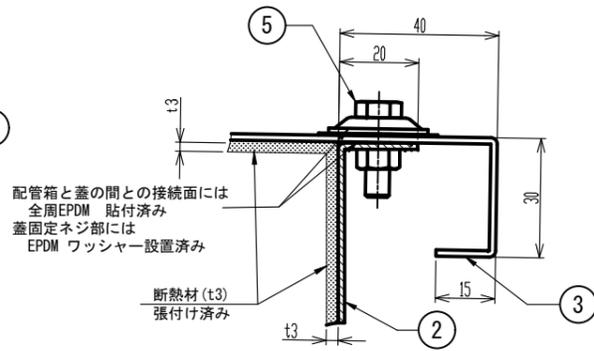
DETAIL A (蓋-配管箱 接続部)
