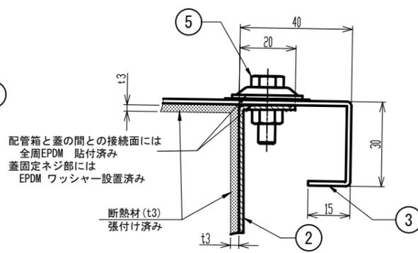
DETAIL A (蓋-配管箱 接続部)
