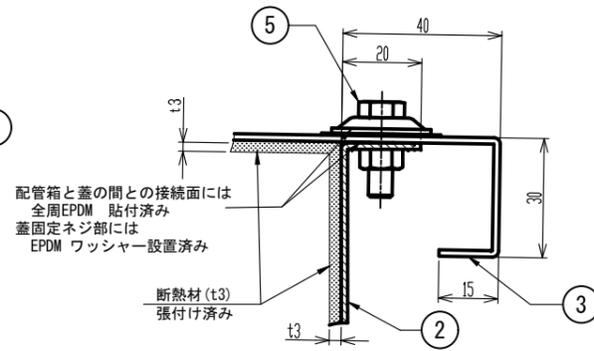
DETAIL A (蓋-配管箱 接続部)
