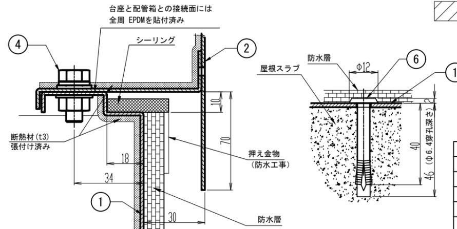
DETAIL B (台座-配管箱 接続部)
